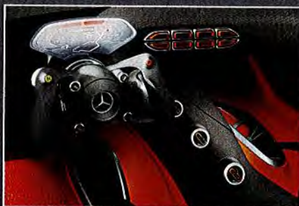
Als Anzeige dient eine Glasscheibe, auf die Informationen eingespiegelt werden
