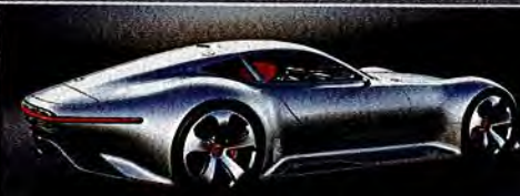
Aerodynamisch ausgefeilte Karosserie mit weit nach hinten versetzter Fahrgastzelle
