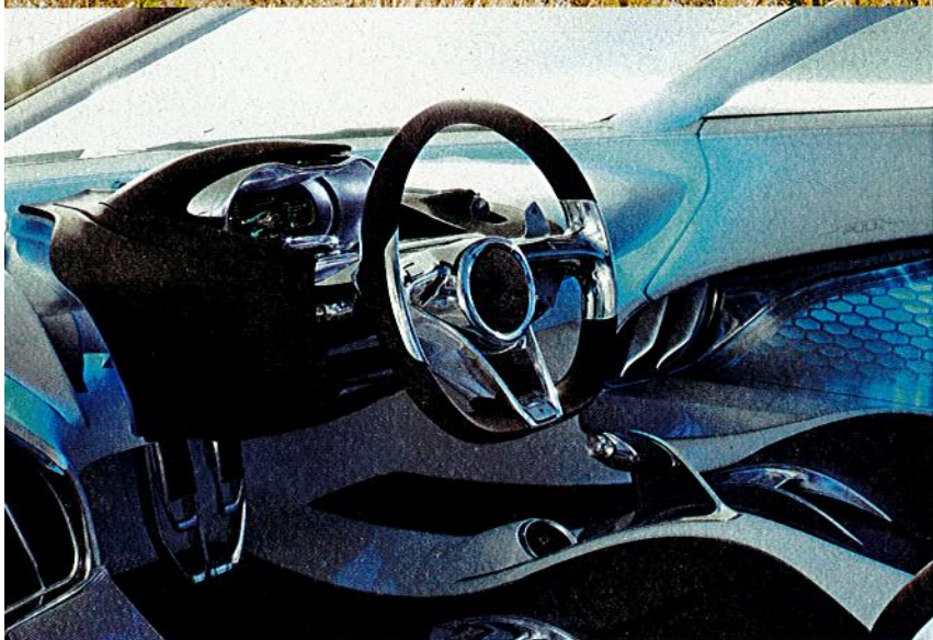
Das Vorfeld leuchtet nachts in strahlendem Weiß, innen dominiert im Ruhezustand kräftiges Blau. Die Rundinstrumente sind frei programmierbar. Unten: im Bild das klassische Wechselspiel von Tempo (links, 205 mph) und Kraft (rechts, 580 kW)
