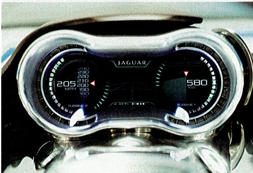
Das Vorfeld leuchtet nachts in strahlendem Weiß, innen dominiert im Ruhezustand kräftiges Blau. Die Rundinstrumente sind frei programmierbar. Unten: im Bild das klassische Wechselspiel von Tempo (links, 205 mph) und Kraft (rechts, 580 kW)
