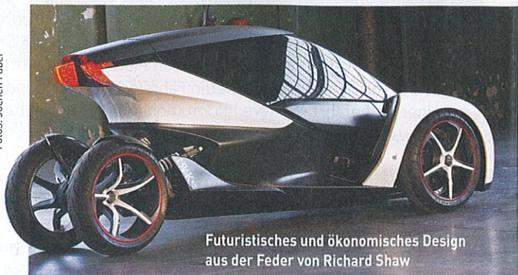
... und an einer Schwinge aufgehängte Hinterachse mit nur 60 Zentimeter Spur
