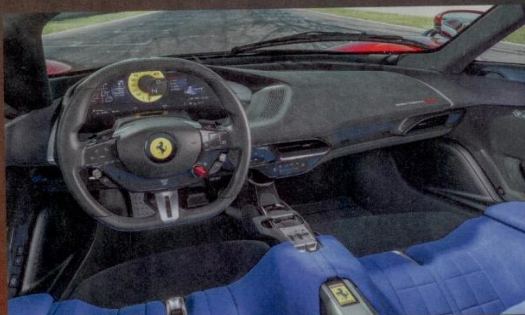
Die Schalensitze sind nicht verstellbar, nur die Pedalarie und das Lenkrad lassen sich justieren
